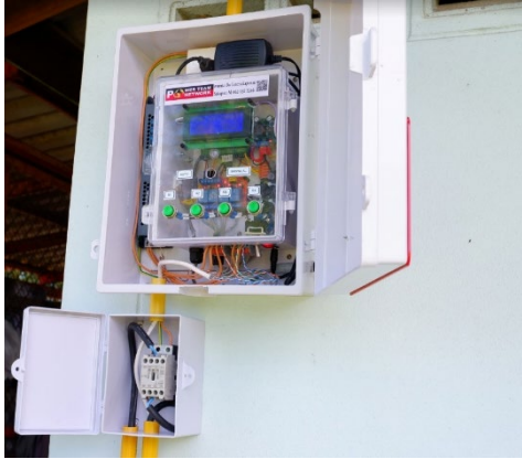
รูปที่ 2 อุปกรณ์ Smart Farm สำหรับจ่ายน้ำแยกตามแปลงเกษตร
